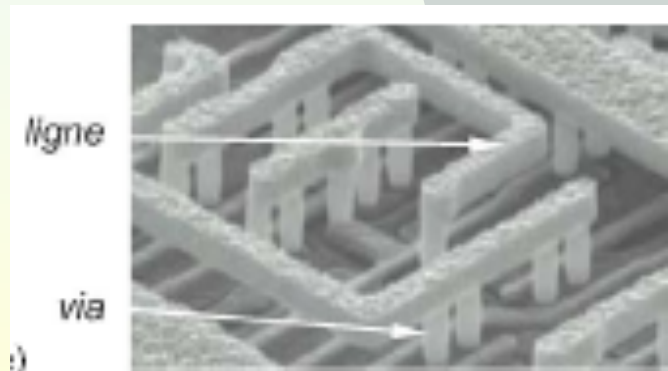
Réseau de connections en cuivre
