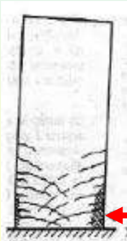
Ecrasement du béton comprimé
