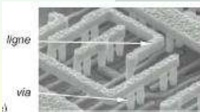
Réseau de connections en cuivre
